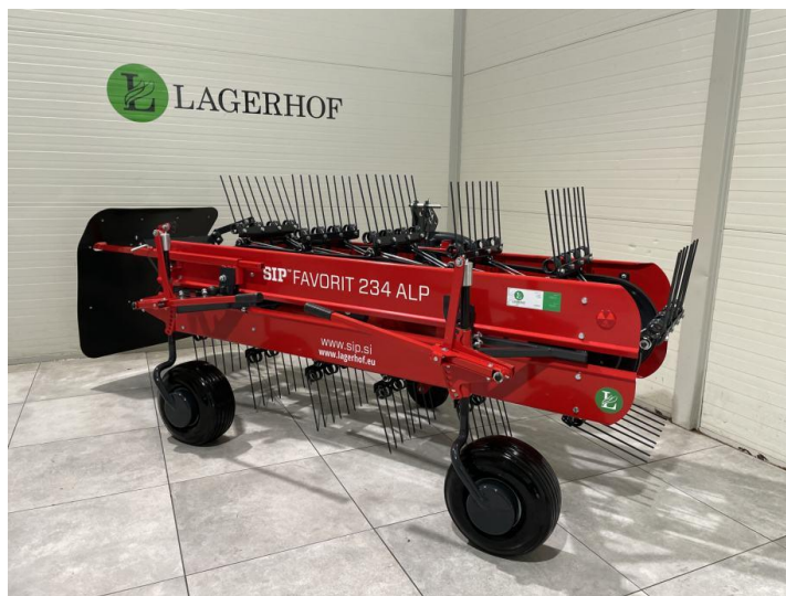
Slika 10. Grablje sa beskrajnom trakom s elastičnim zupcima (SIP).
