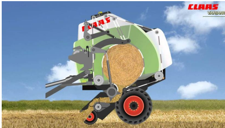
Slika 14. Prikaz rada valjčaste preše s elastičnom komorom.
