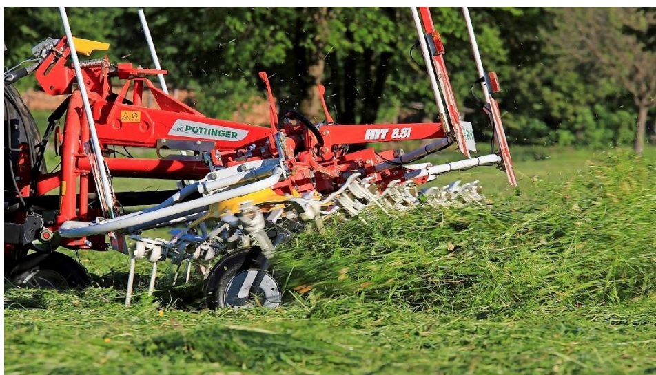
Slika 8. Rotacijski okretač u radu (Pöttinger).
