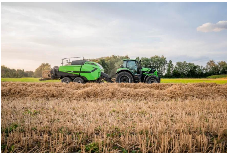
Slika 13. Velika vučena preša (Deutz Fahr).
