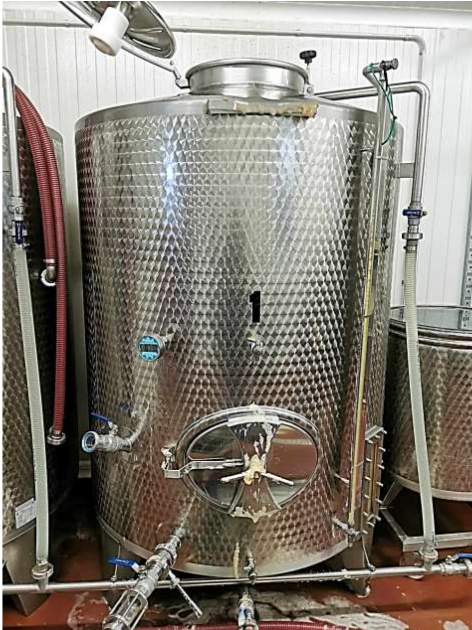
Slika 7. Inox cisterna količine 2.000 litara
