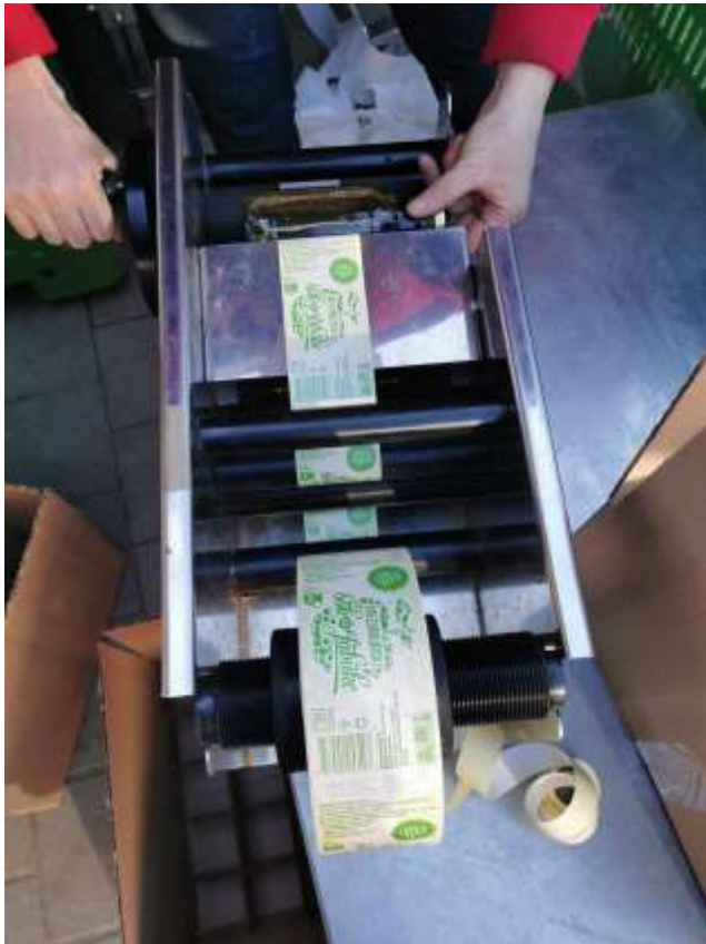
Slika 14. Uređaj za stavljanje etiketa
