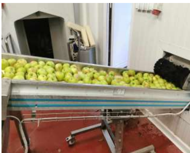
Slika 2. Elevator za transport jabuka na pranje, Izvor: vlastita fotografija
