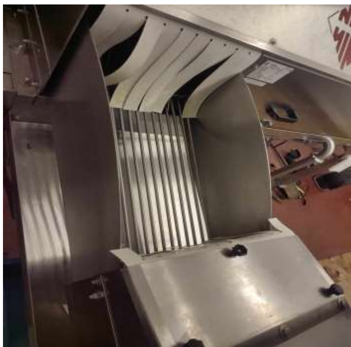
Slika 4. Uređaj za prešanje jabuka
