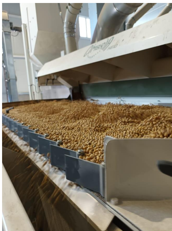
Slika 17. Dorada sjemena soje na gravitacijskom stolu
