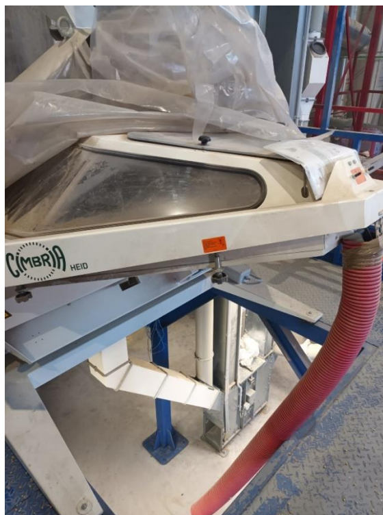
Slika 18. Uređaj za odvajanje kamenja (destoner)
