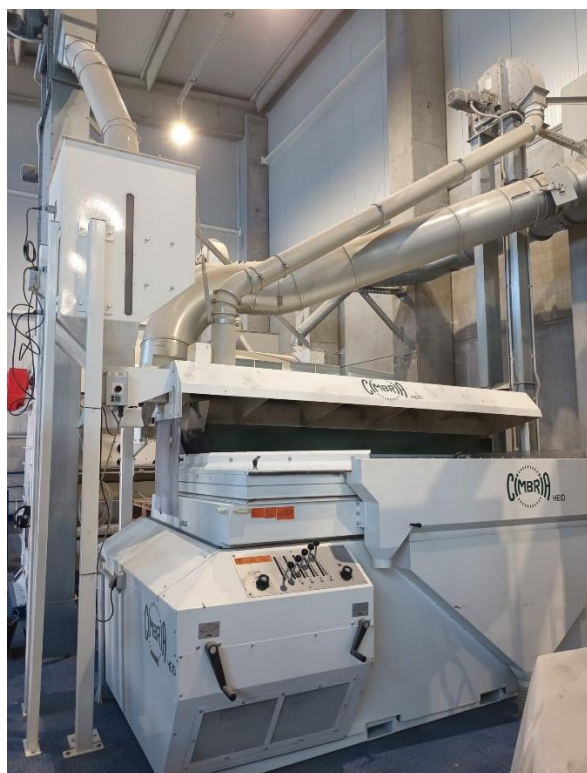
Slika 15. Gravitacijski separator ili stol
