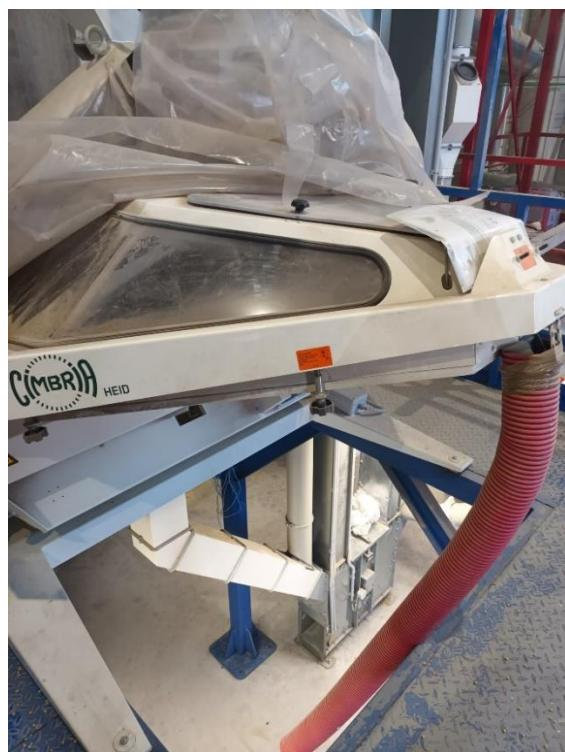
Slika 18. Uređaj za odvajanje kamenja (destoner)
