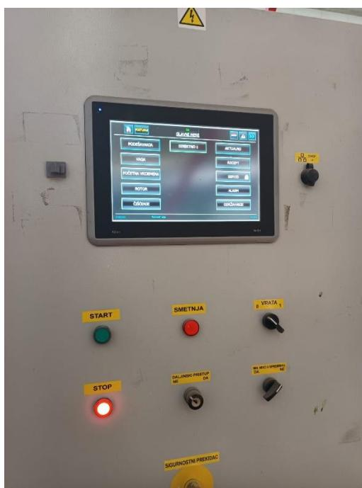
Slika 23. Zaslon za određivanje parametara
