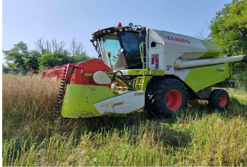
Slika 12. Prikaz kombajna Class Tucano 430 APS u žetvi uljane repice
