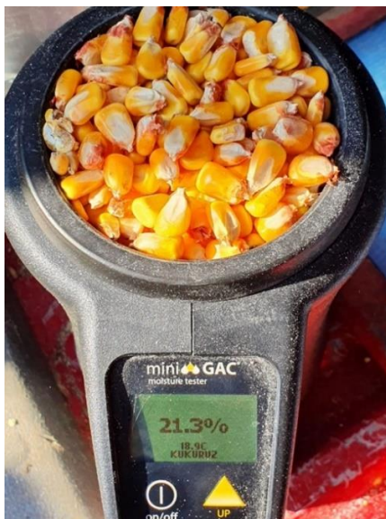
Slika 4. Mjerenje vlage kukuruza
