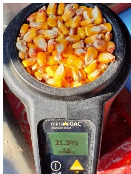
Slika 4. Mjerenje vlage kukuruza
