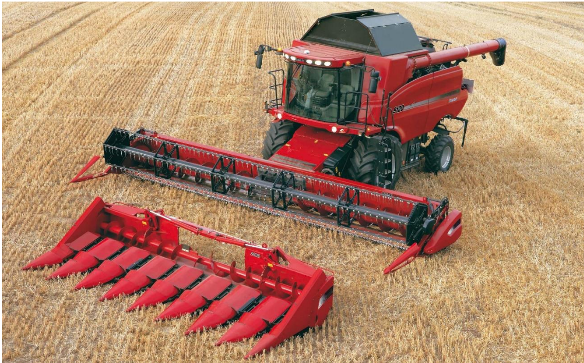
Slika 2. Suvremeni samokretni univerzalni kombajn s različitim uređajima za žetvu
