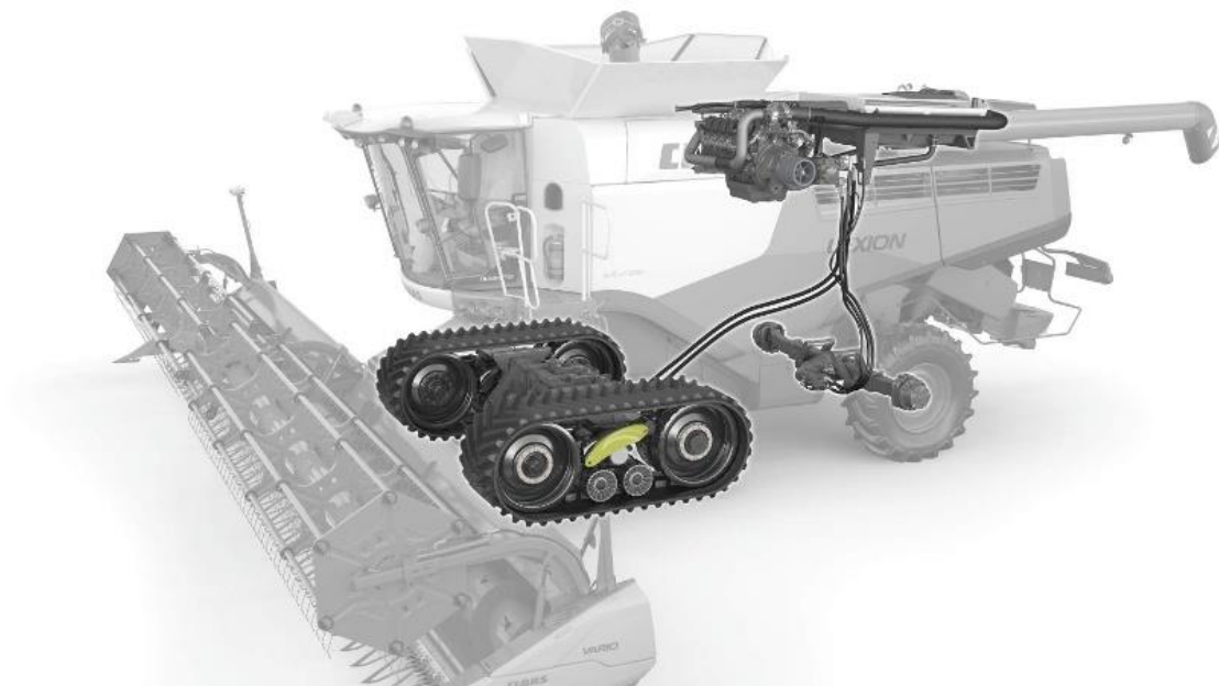
Slika 10. Shematski prikaz kombajna s tracionim elementima
