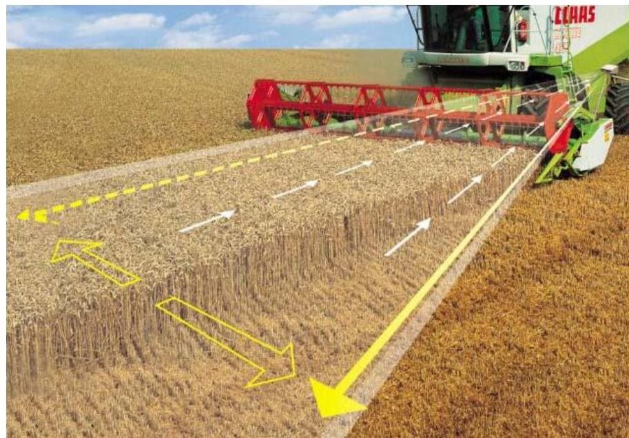
Slika 14. Prikaz automatiziranog upravljanja kombajnom
