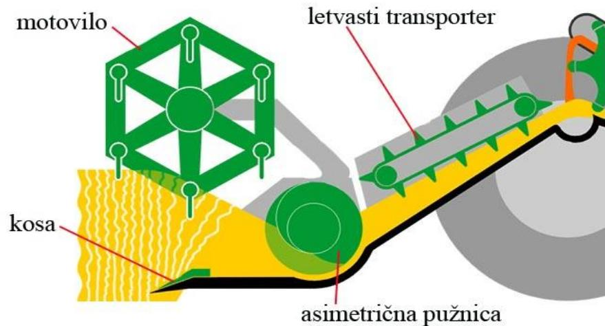
Slika 4. Shematski prikaz rada uređaja za košnju
