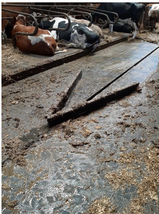
Slika 18. Izgnojavanje automatskim krilnim čistačem Izvor: Vlastita fotografija
