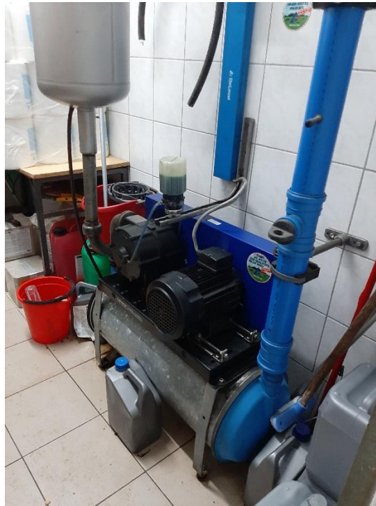
Slika 11. Pogonska jedinica muznog uređaja DeLaval Izvor: Vlastita fotografija
