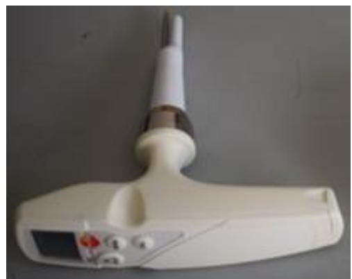
Slika 29. Digitalni pH metar (Testo 205, USA)
