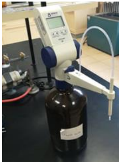
Slika 28. Digitalna kontinuirana bireta (Boeco DCB 5000, Njemačka)
