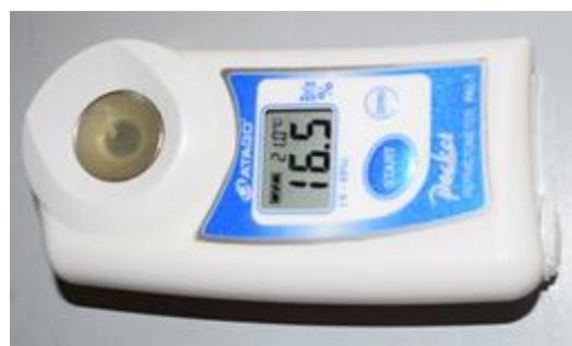
Slika 27. Digitalni refraktometar (ATAGO PAL-1, Japan)
