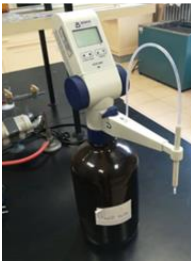
Slika 28. Digitalna kontinuirana bireta (Beeco DCB 5000, Njemačka)
