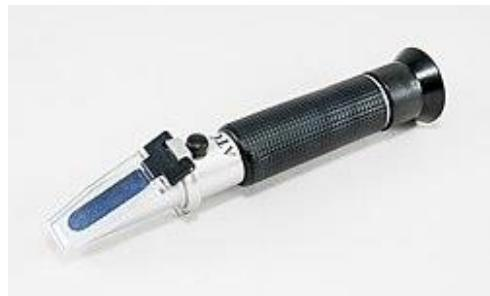
Slika 10. Refraktometar
