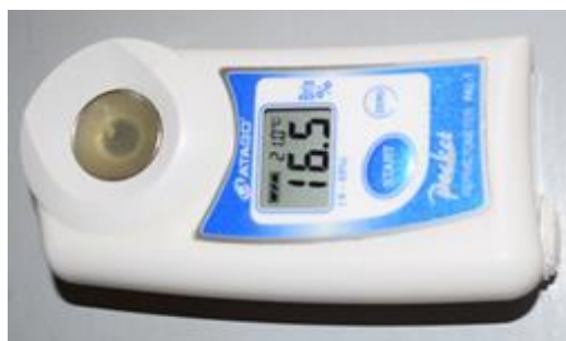
Slika 27. Digitalni refraktometar (ATAGO PAL-1, Japan) Izvor: Skendrović Babojelić, 2021.
