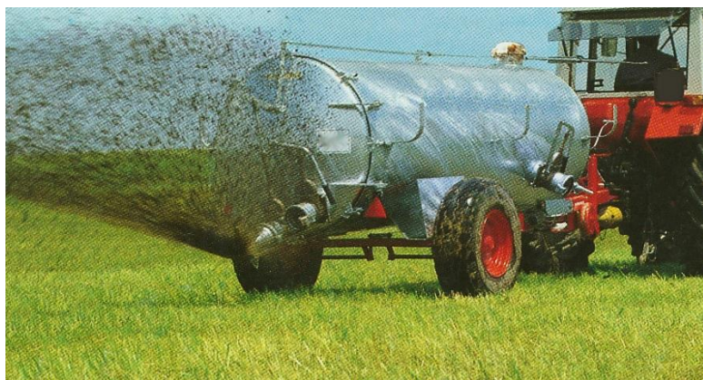
Slika 11. Primjena gnojovke raspršivanjem
