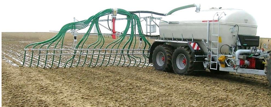
Slika 12. Primjena gnojovke izlivanjem po površini
