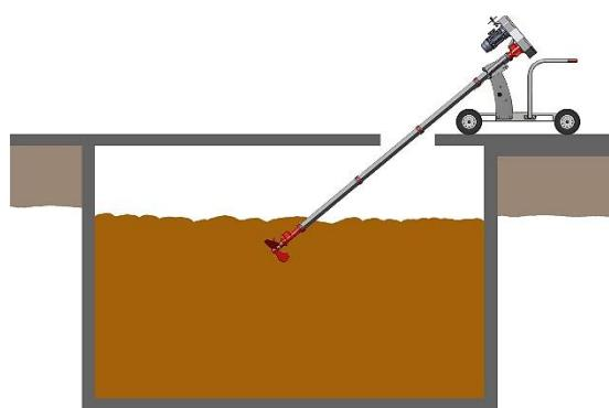
Slika 8. Miješanje gnojovke pokretnim uređajem s EM pogonom
