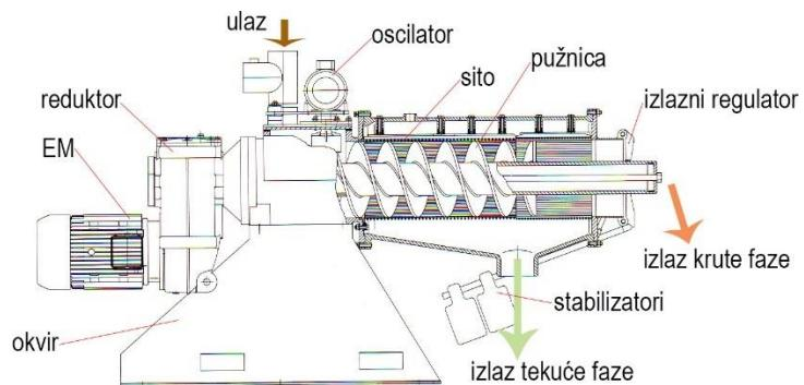
Slika 23. Osnovni elementi horizontalnog roto separatora
