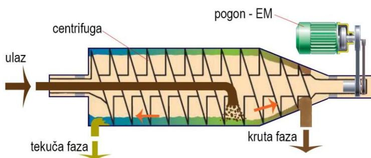
Slika 25. Shematski prikaz načina rada centrifugalnog separatora
