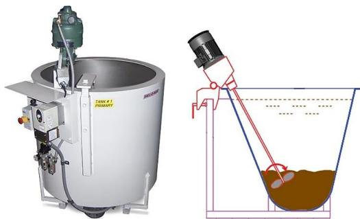
Slika 6. Prikaz uređaja za mehaničku obradu gnojovke
