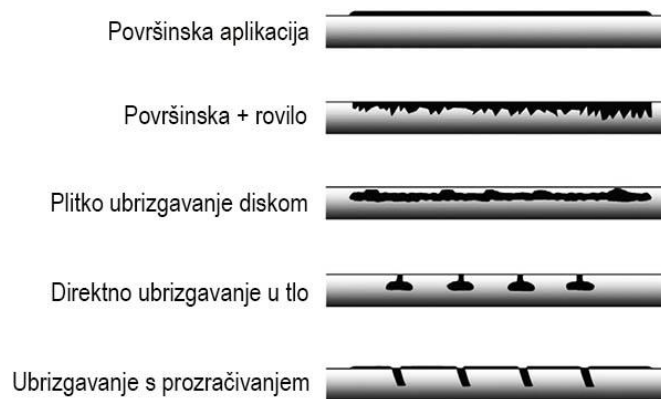
Slika 1. Različiti načini primjene gnojovke (Brandt i sur. 2011.)
