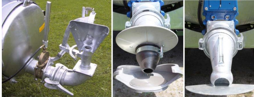
Slika 17. Prikaz različitih sklopova za dezintegraciju mlaza
