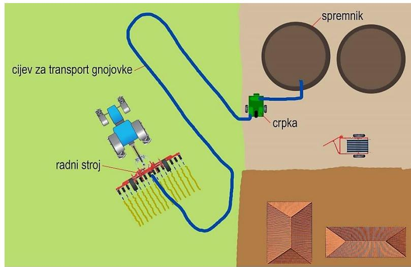
Slika 10. Shematski prikaz polupokretnog sustava primjene gnojovke
