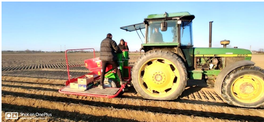
Slika 20. Traktor i dvoredna sadilica
