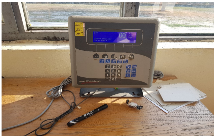
Slika 6. „Display“ na kojem se očitava masa s mostne vage (Fotografija: F. Rutić)
