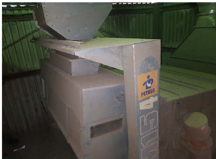
Slika 14. Aspirator Petkus SM15-4, protočnog kapaciteta od 100 t/h
