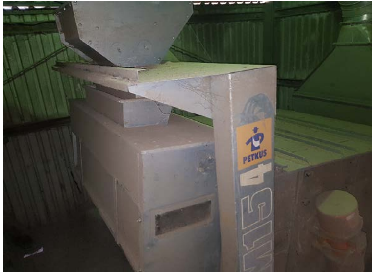
Slika 14. Aspirator Petkus SM15-4, protočnog kapaciteta od 100 t/h
