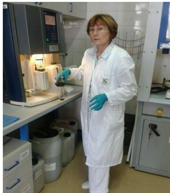
Slika 12. Aparat za destilaciju proteina po Kjeldalhu
