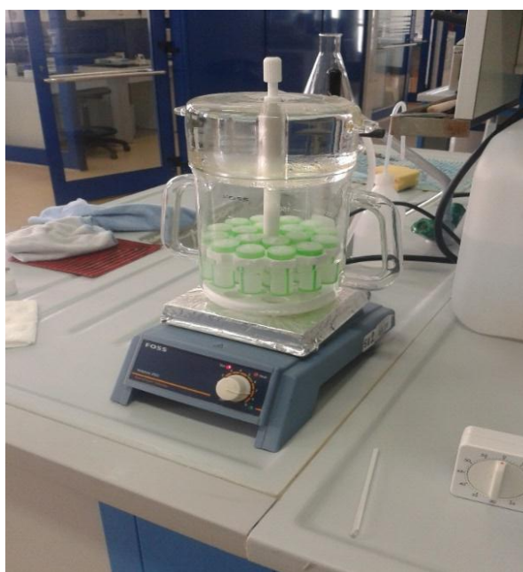
Slika 14. Analizator Fibercap za određivanje sirovih vlakana
