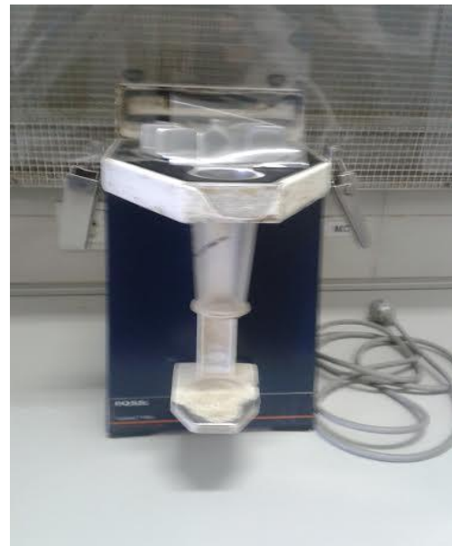
Slika 7. Mlin za sitno mljevenje uzoraka
