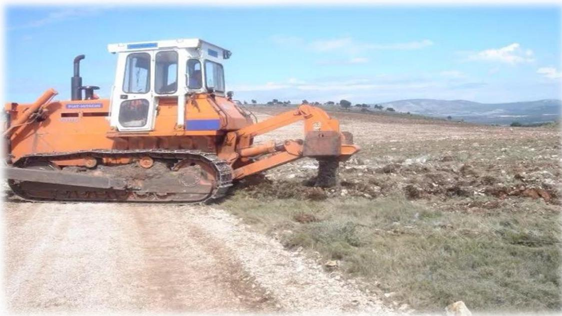
**Slika 7: Rad podrivačem u pripremi sadnje vinograda tvrtke Vinoline**
