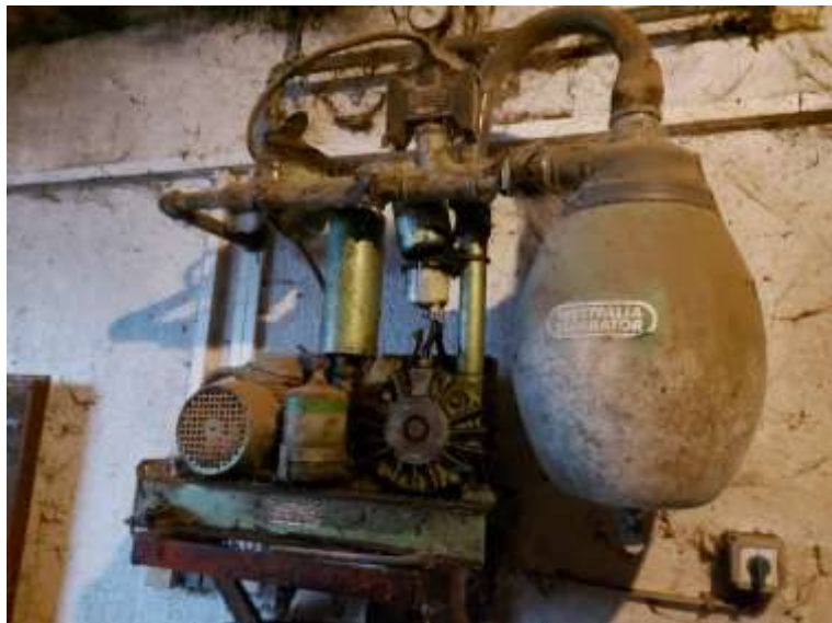
Slika 11. Pogonska jedinica muznog uređaja Westfalia
