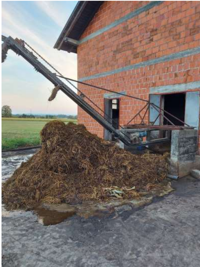
Slika 16. Vanjski transporter za gnoj
