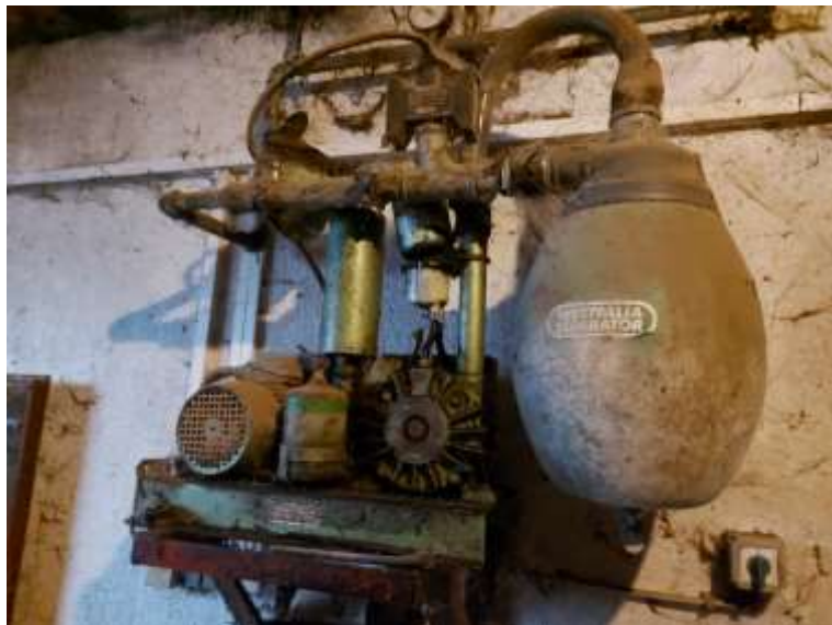
Slika 11. Pogonska jedinica muznog uređaja Westfalia
