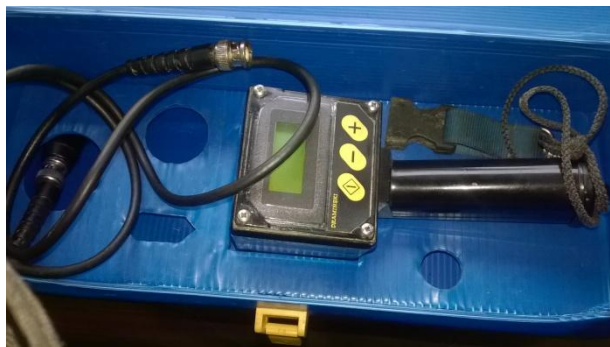
Slika 4.: Aparat za mjerenje leđne slanine
