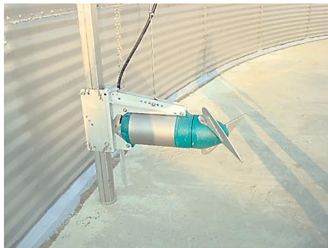
Slika 8. Fiksni mikser za gnojovku Stallkamp (Izvor: Vlastita fotografija)
