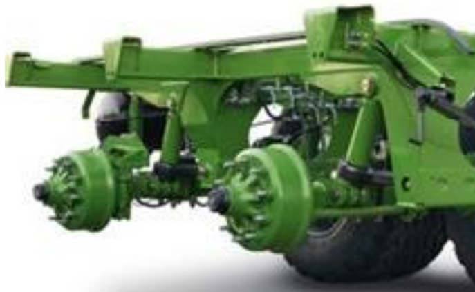
Slika 11. Uređaj za suspenziju kotača (Izvor: Vlastita fotografija)
