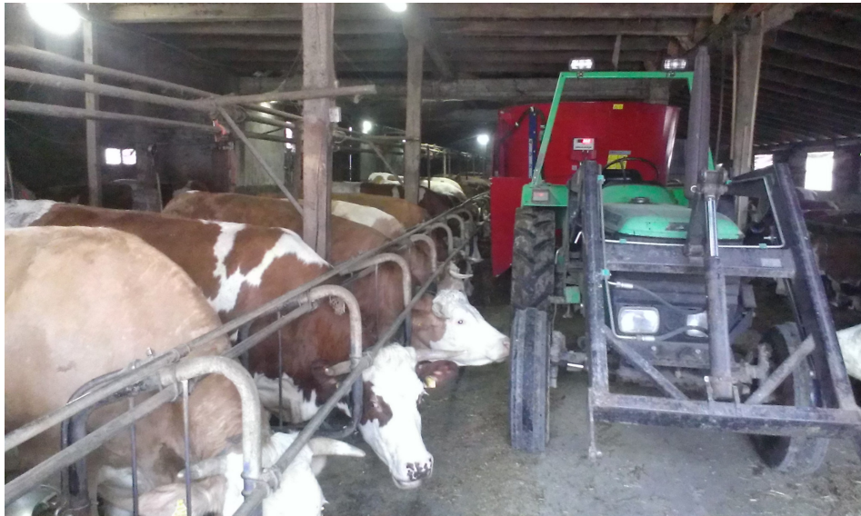
Slika 12. Hranjenje muznih krava mikser (TMR) prikolicom
