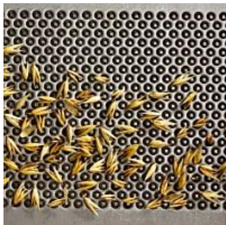
Slika 10. Ćelije unutar selektora
