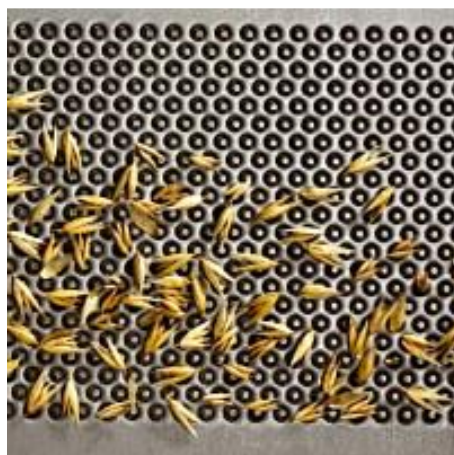
Slika 10. Ćelije unutar selektora
