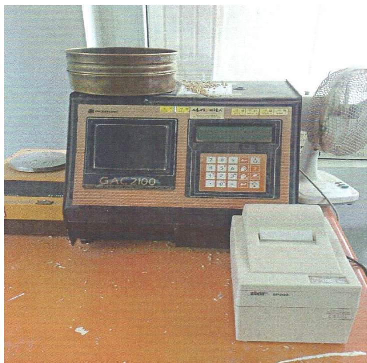
Slika 1. Dickey John, printer za ispis rezultata, vaga i sito za određivanje primjesa
