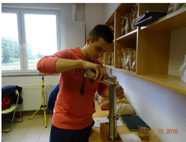
Slika 13. Određivanje hektolitarske mase
