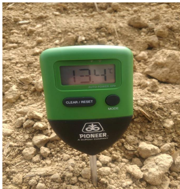
Slika 20. Uređaj za mjerenje temperature tla
