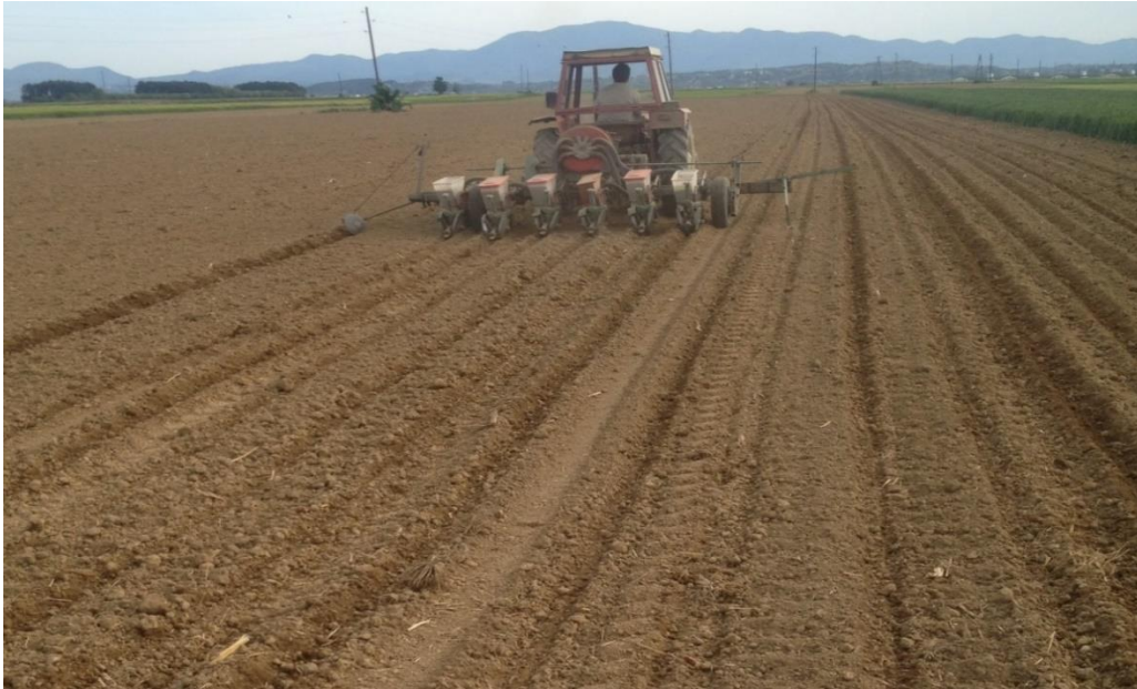
Slika 3. Sjetva graha pomoću kombinacije traktora Massey Ferguson 135 i pneumatske sijačice OLT Izvor: (vlastita fotografija I.P.)
