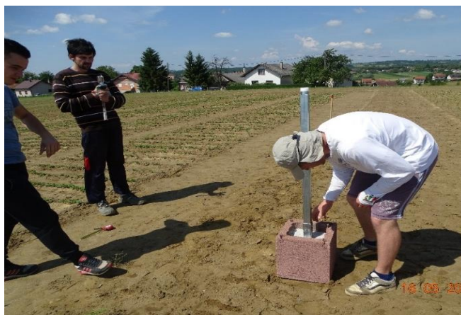
Slika 9. Postavljanje irigometra i meteo stanice
