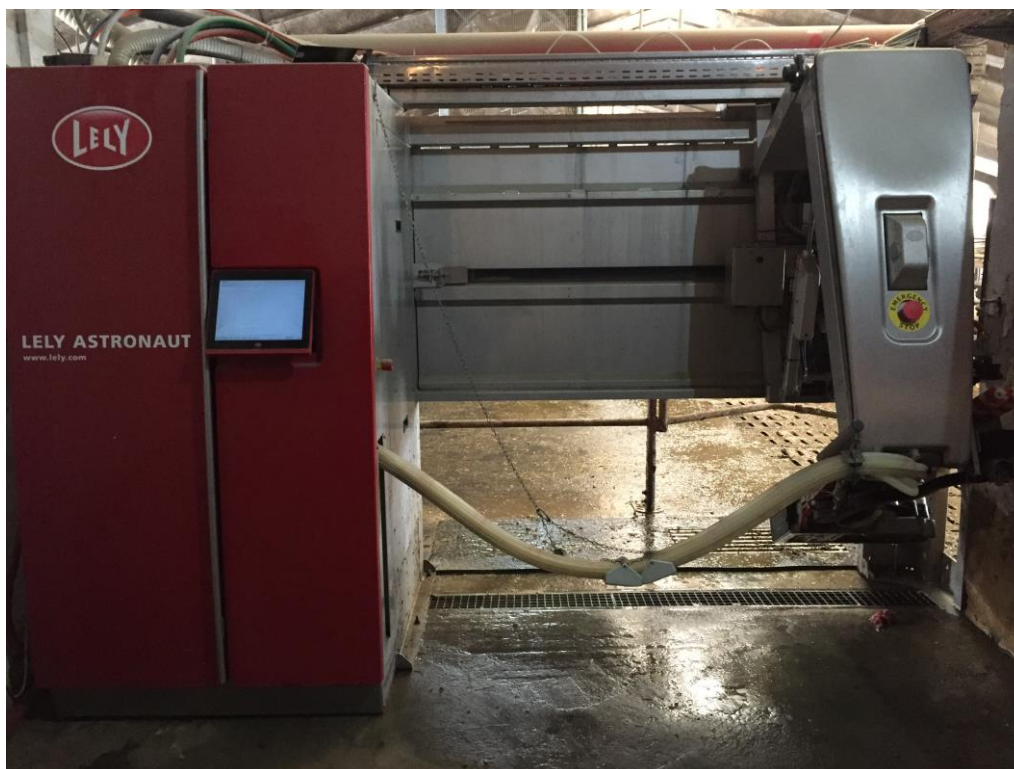
Slika 6. Robot za mužnju Lely Astronaut
