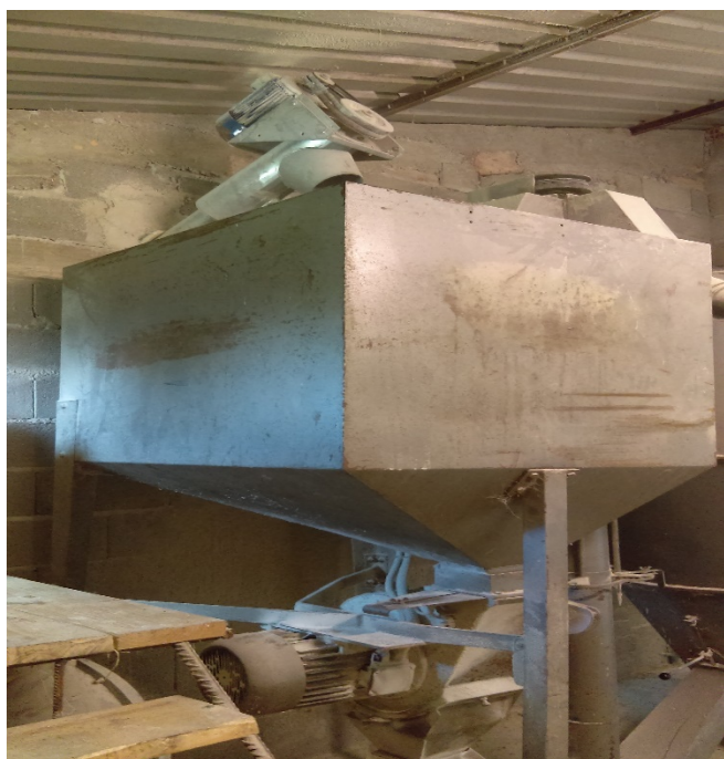
Slika 19. Mješaona stočne hrane na farmi OPG-a
