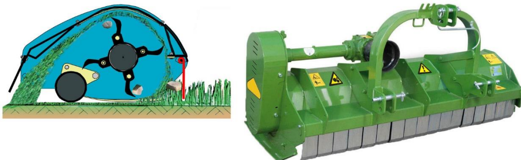
Slika 7. Prikaz uređaja za usitnjavanje korova (malčer)
