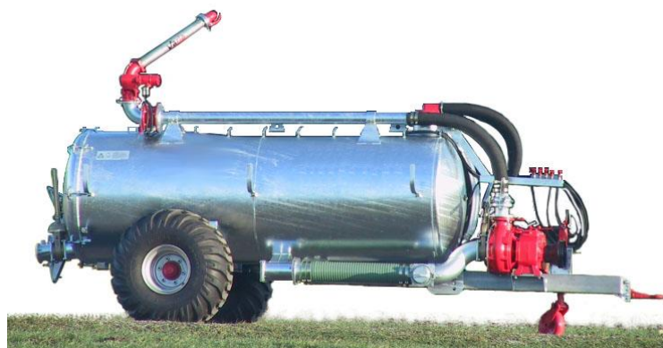
Slika 22. Prikaz sklopa za usmjeravanje mlaza (tyfon)
