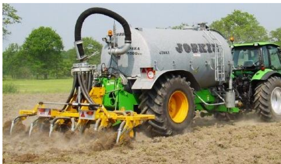
Slika 13. Prikaz uređaja u postupku ulaganja gnojovke u tlo
