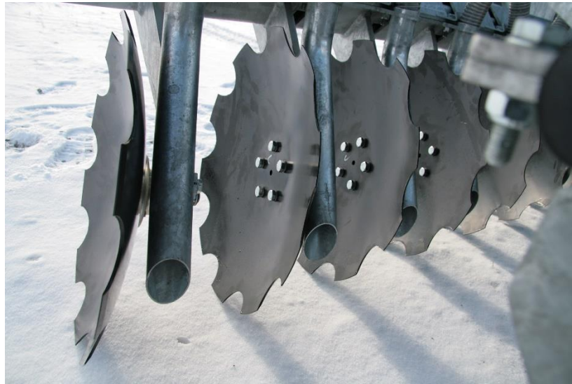
Slika 33. Prikaz diskosnog ulagača gnojovke
