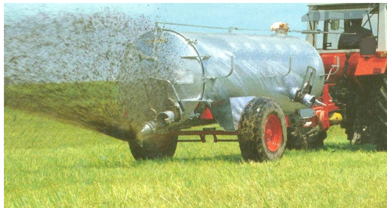
Slika 11. Prikaz uređaja za raspršivanje gnojovke
