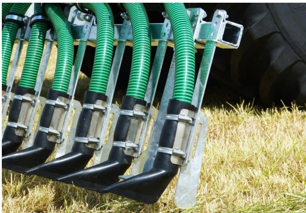
Slika 32. Prikaz raoniočnog ulagača gnojovke
