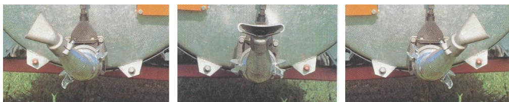
Slika 21. Prikaz mogućnosti usmjeravanja mlaza
