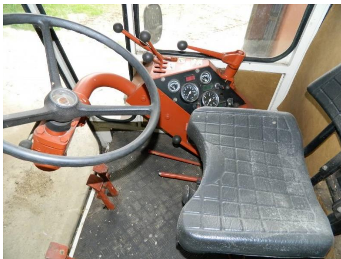
Slika 9. Prikaz unutrašnjosti kabine kombajna Fiat Laverda 3300 AL
