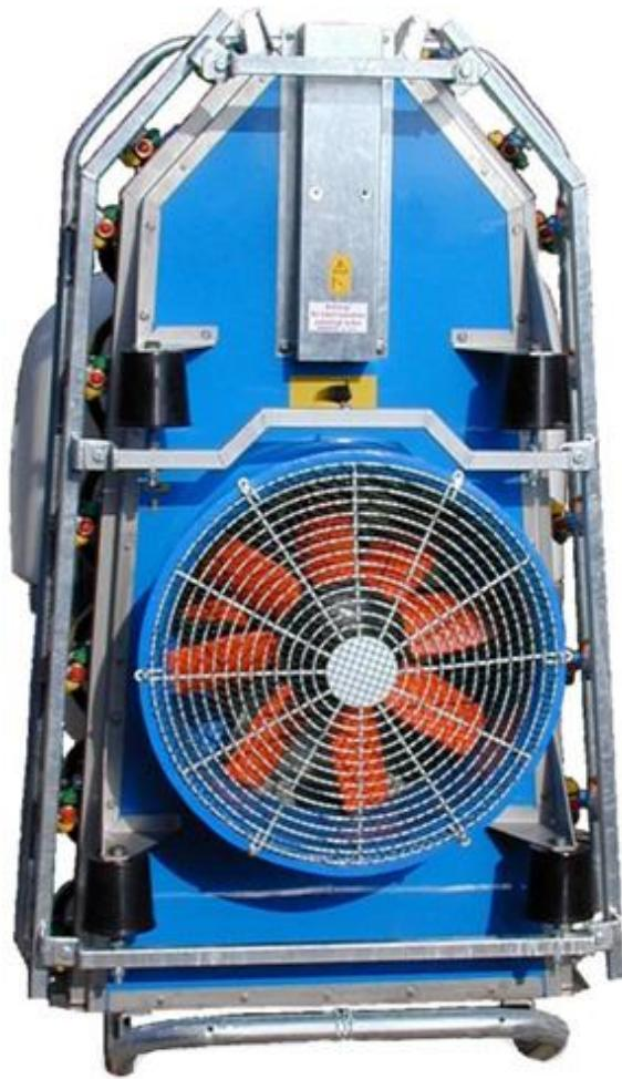
Slika 10: Ventilatori i visoki usmjerivač zraka
