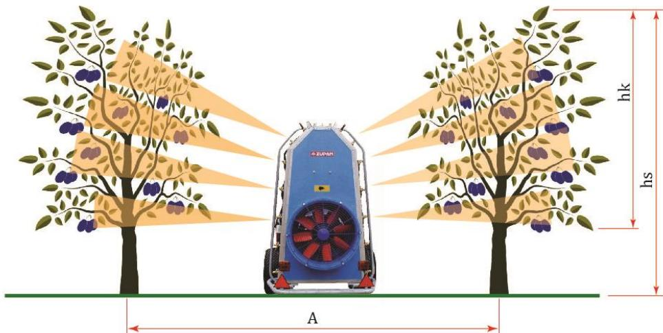
Slika 11. Shematski prikaz rada uređaja Zupan DT1000
