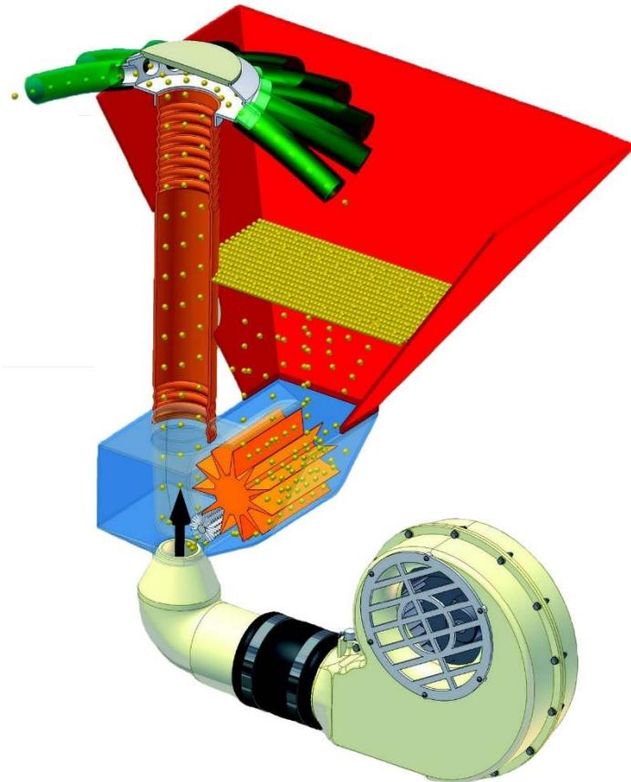
Slika 7. Shematski prikaz rada sijačice VogelNoot Power Drill A300
