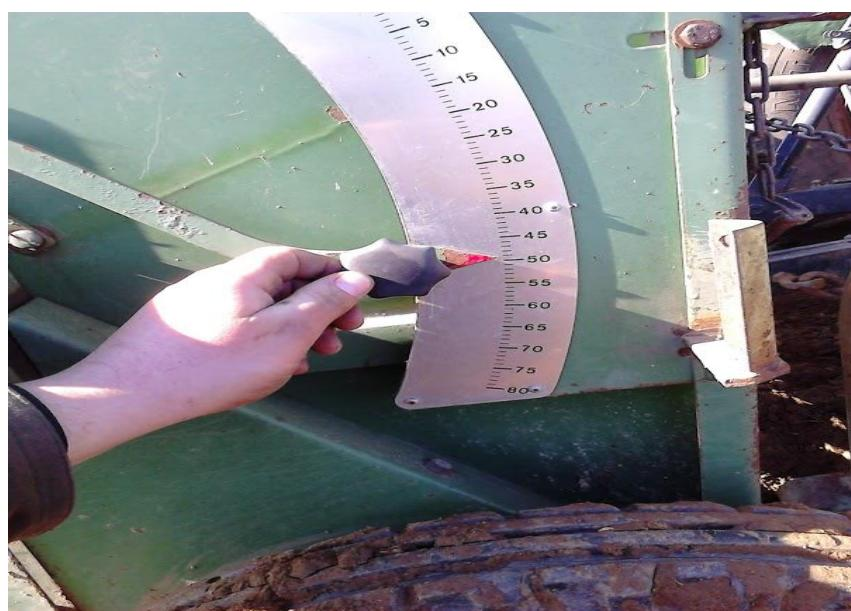
Slika 2. Podešavanje otvora unutar sjetvenog spremnika
