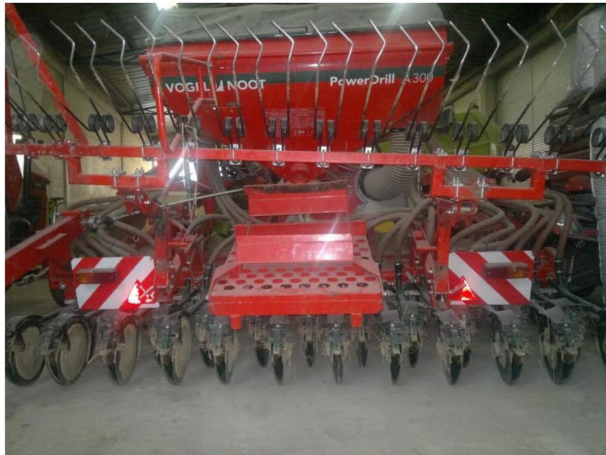
Slika 8. Pneumatska sijačica VogelNoot Power Drill A300
