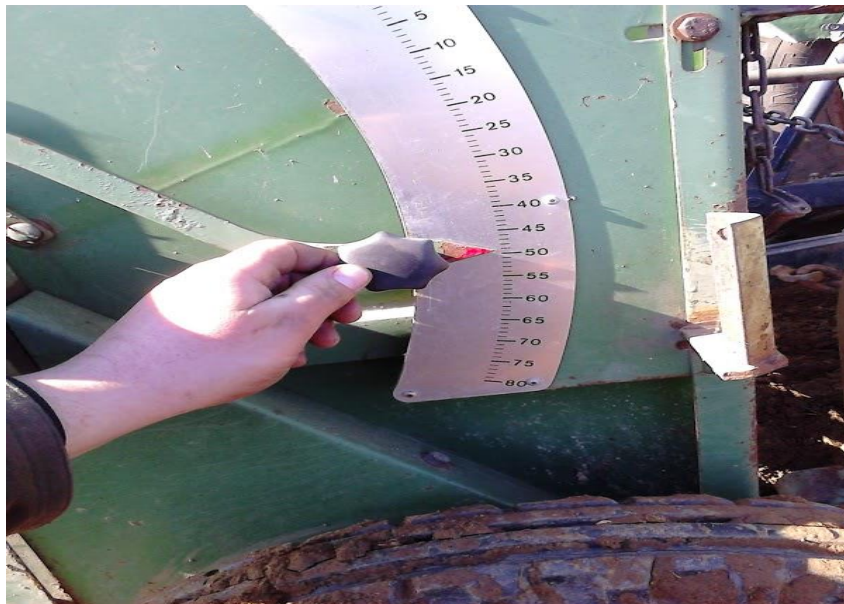
Slika 2. Podešavanje otvora unutar sjetvenog spremnika (Izvor: V. Miloš)
