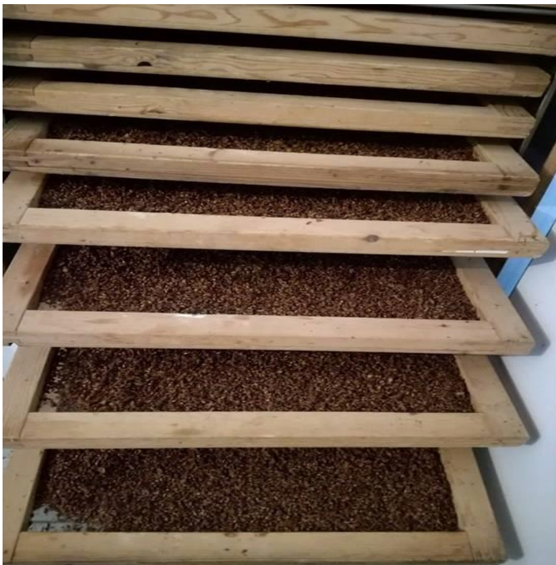
Slika 8: Sušenje sjemenki grožđa u sušari
