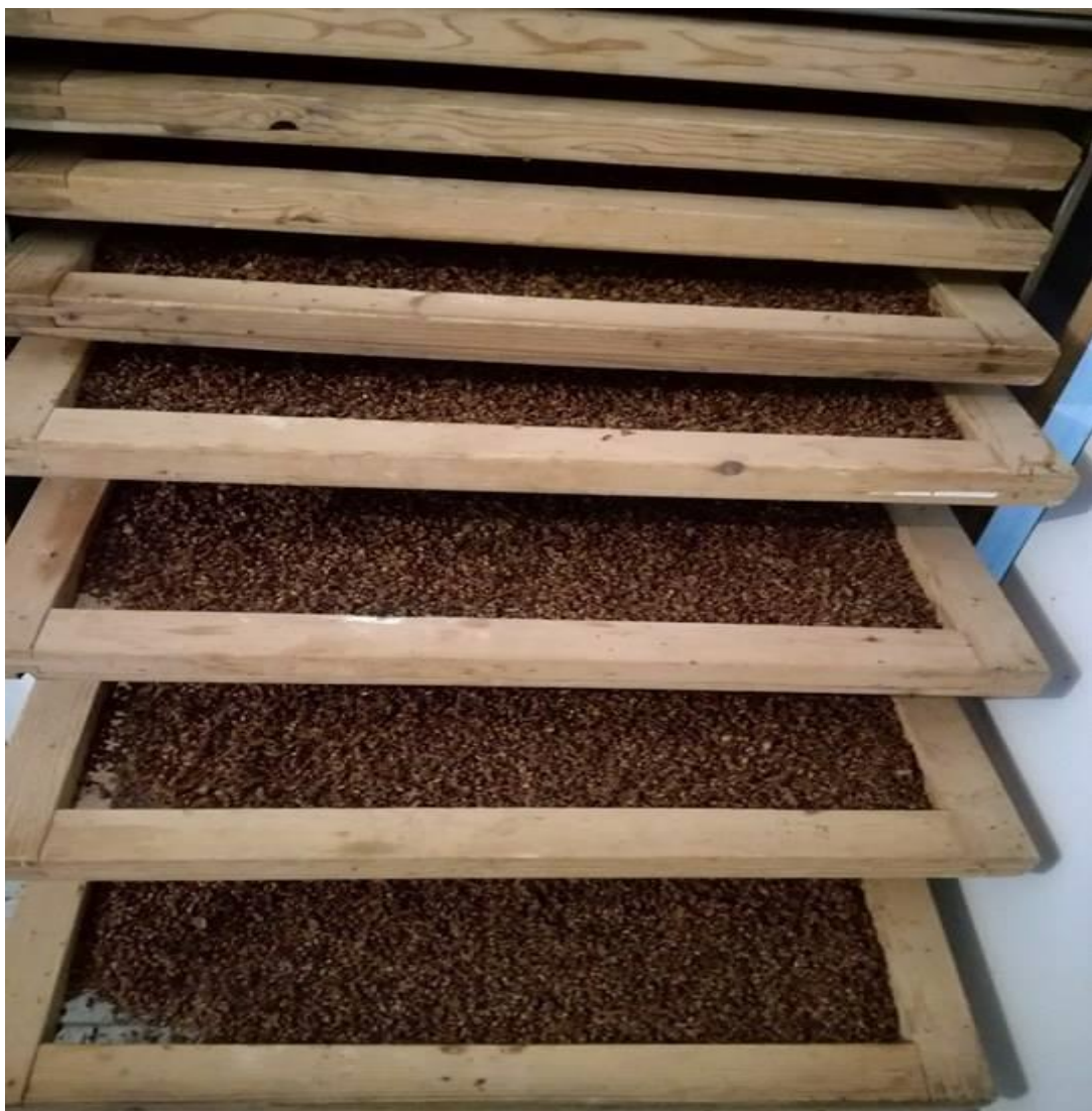
Slika 8: Sušenje sjemenki grožđa u sušari
