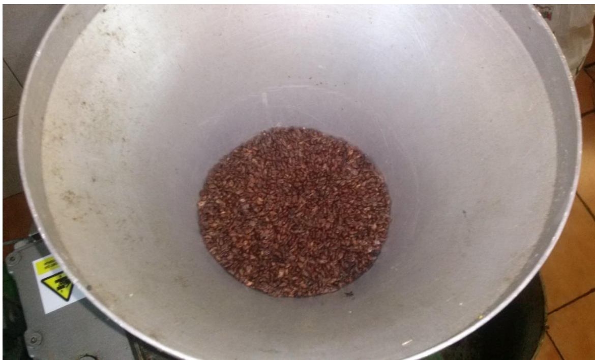
Slika 14: Usipni koš za sjemenke s mlinom na dnu kućišta
