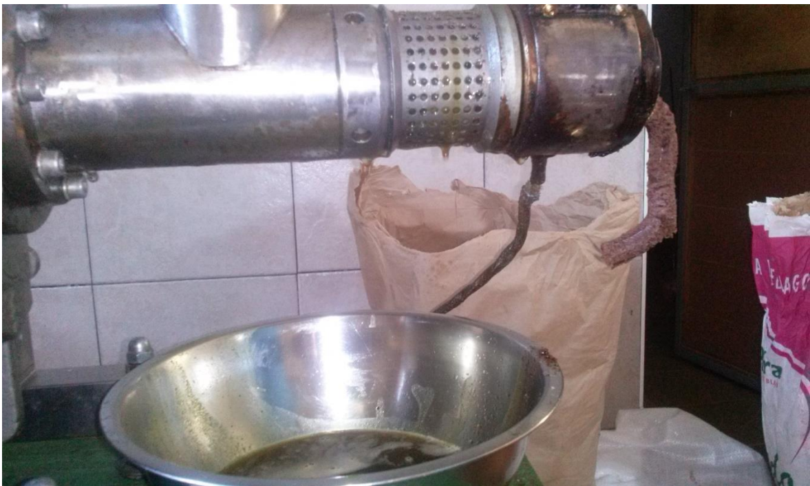
Slika 13: Postupak hladnog prešanja ulja iz sjemenki grožđa
