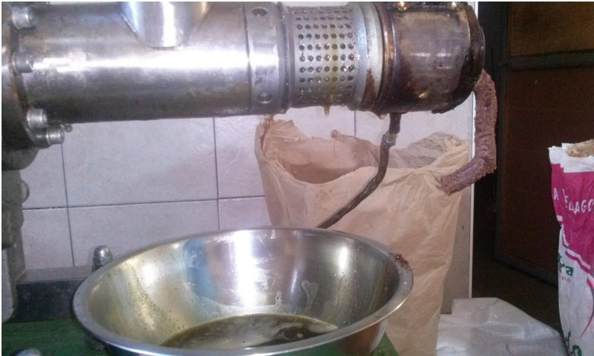
Slika 13: Postupak hladnog prešanja ulja iz sjemenki grožđa
