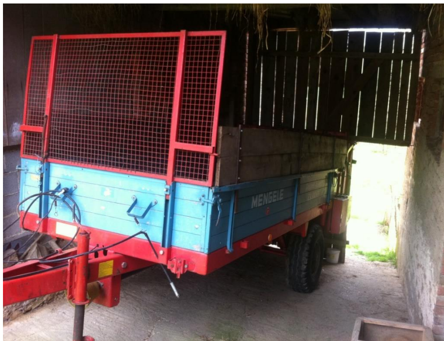
Slika 10. Prikolica za stajski gnoj, MENGELE
