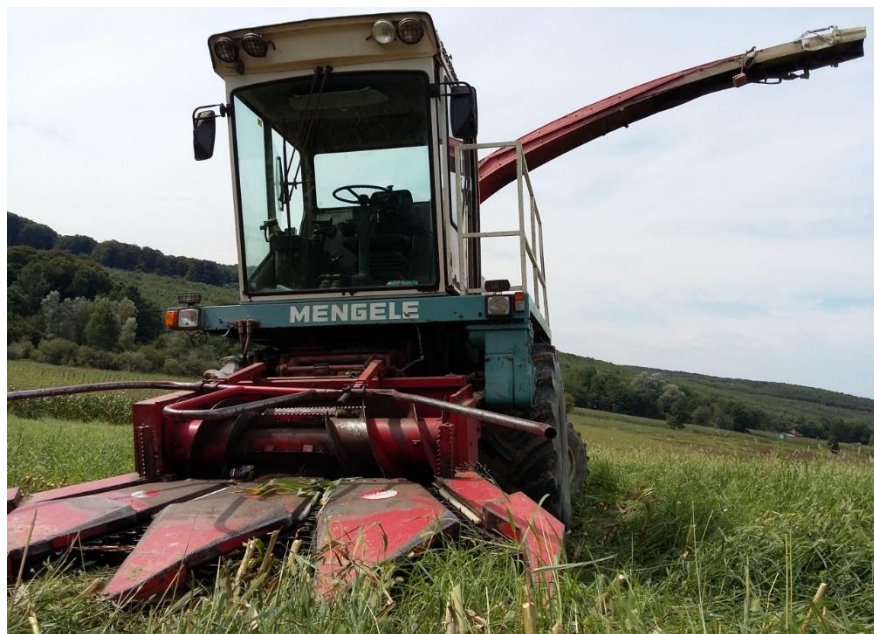
Slika 13: Samohodni silokombajn MENGELE
