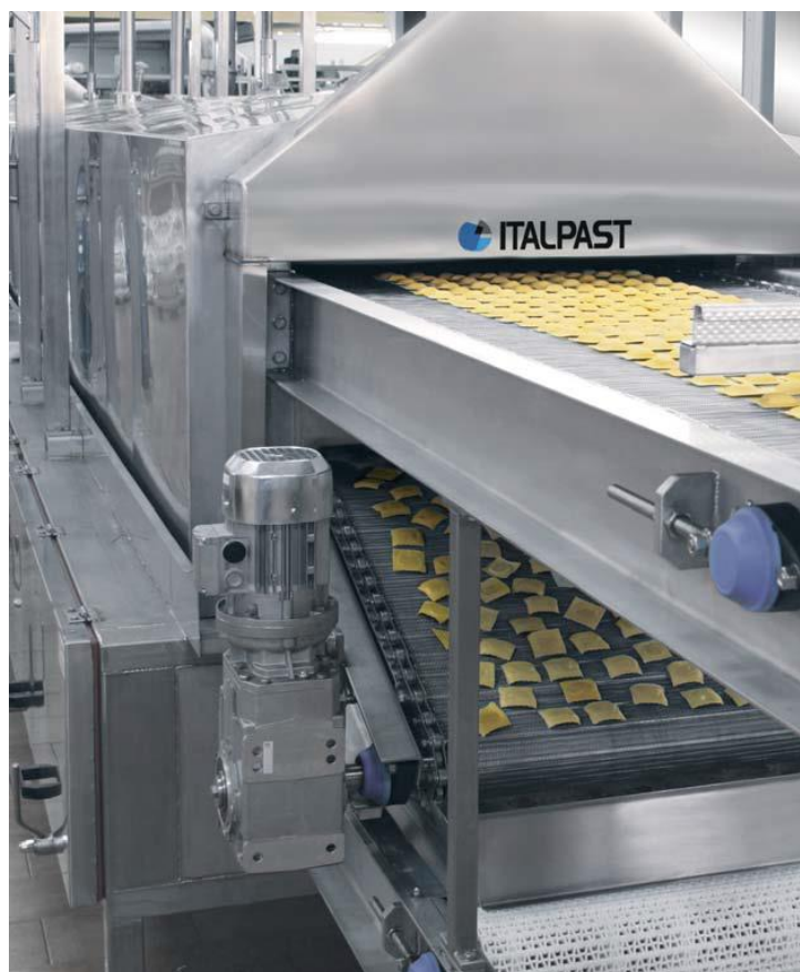
Slika 9. Pred-sušara mod. TP 200/5 E-P Izvor: Internet stranica http://www.italpast.it/
