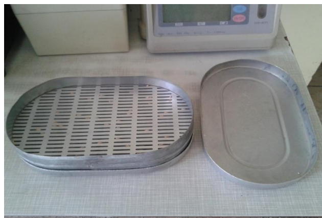
Slika 5. Pozicija 4 - sito za određivanje primjese
