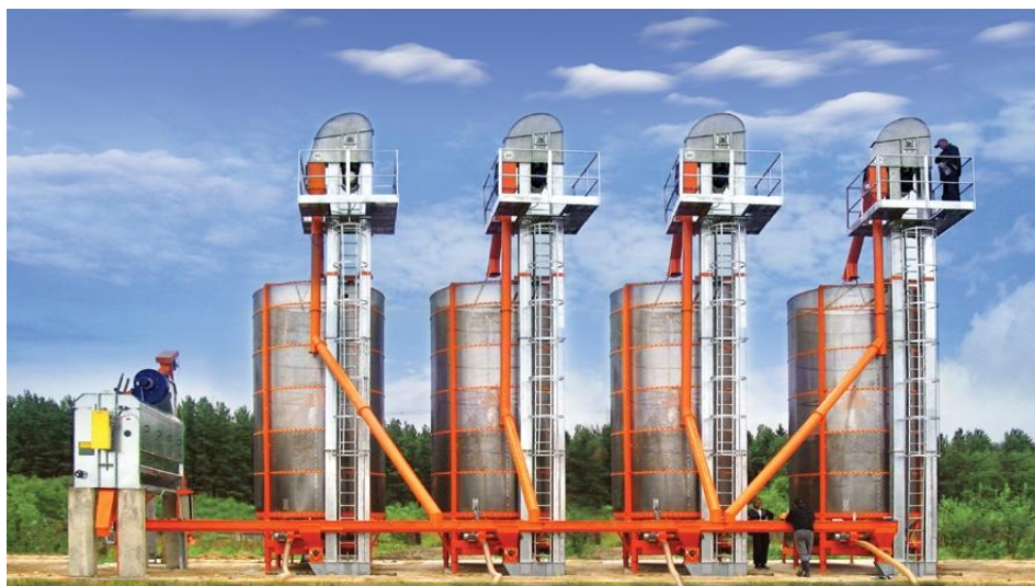
Slika 19. (4 sušare Agrex PRT250/FE)
