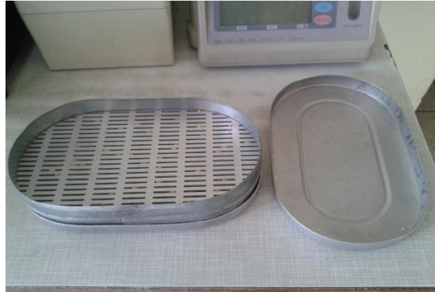
Slika 5. Pozicija 4 - sito za određivanje primjese
