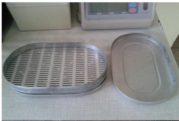
Slika 5. Pozicija 4 - sito za određivanje primjese
