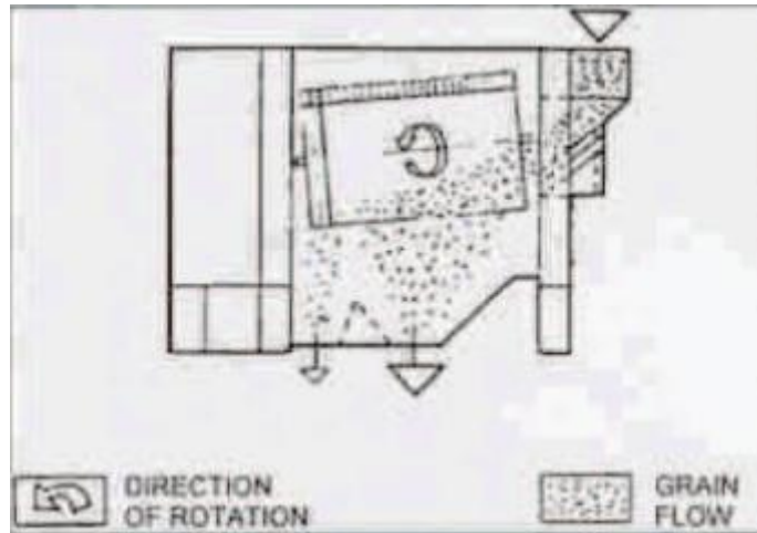
Slika 18. Prikaz rada Marot prečistača
