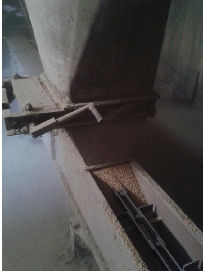
Slika 14. Pozicija 9 - izuzimanje merkantilne pšenice iz silosa 500 t Izvor: vlastita fotografija (16. srpanj 2014.)
