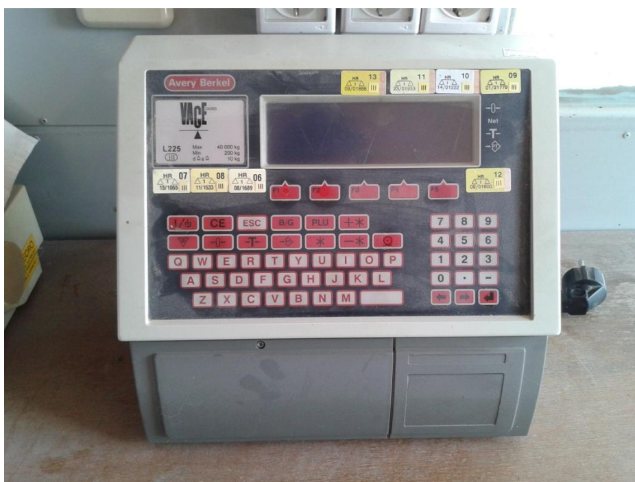
Slika 7. Upravljačko-pokazni uređaj mosne vage
