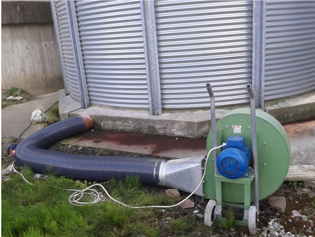
Slika 12. Pozicija 7 - aktivna ventilacija običnim zrakom
