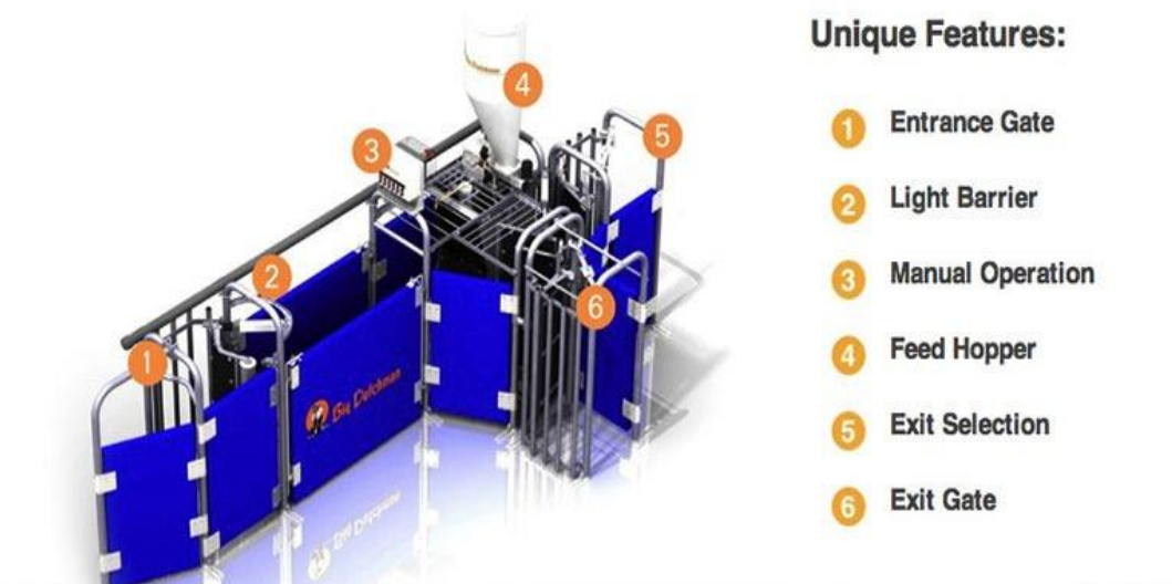
Slika 14. Shema hranidbene postaje Big Dutchman Callmatic sa 1.) ulaznim vratima, 2.) senzorom, 3.) računalom za ručne postavke, 4.) hranilicom, 5.) selekcijskim izlazom i 6.) izlaskom nazad u boks.
