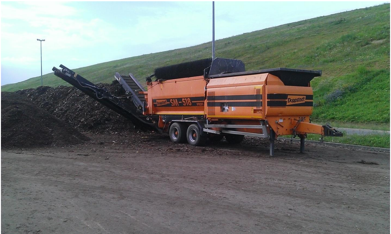
Slika 13. „Doppstadt SM-518“ stroj za prosijavanje komposta
