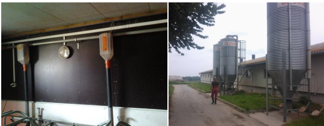
Slika 12. Hranidba s cijevnim konvejerom i volumnim dozatorima
